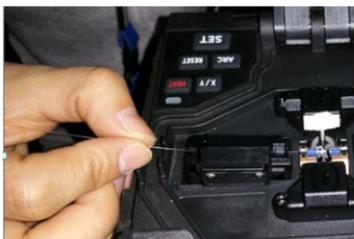
注意：在熔接前热缩管应提前套在任意一段光纤上。
