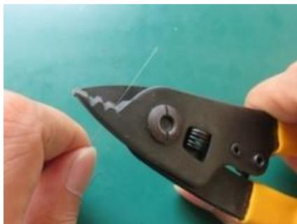
①用光纤剥线钳剥掉外部塑料层
