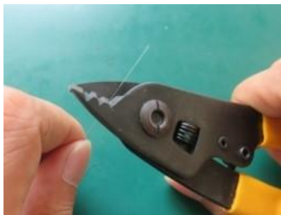
①用光纤剥线钳剥掉外部塑料层
